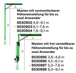
Masten mit vormontierbarer Höheneinstellung ermöglichen eine schrittweise Anpassung der Anschlagpunkthöhe (verstellbar bis 1,5 m) während der Montage.
