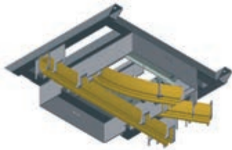
Schiebeweichen Verbindung einzelner Linien
