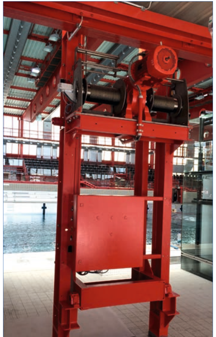
Doppeltrommel-Hubwinde - im Schwimmbad
