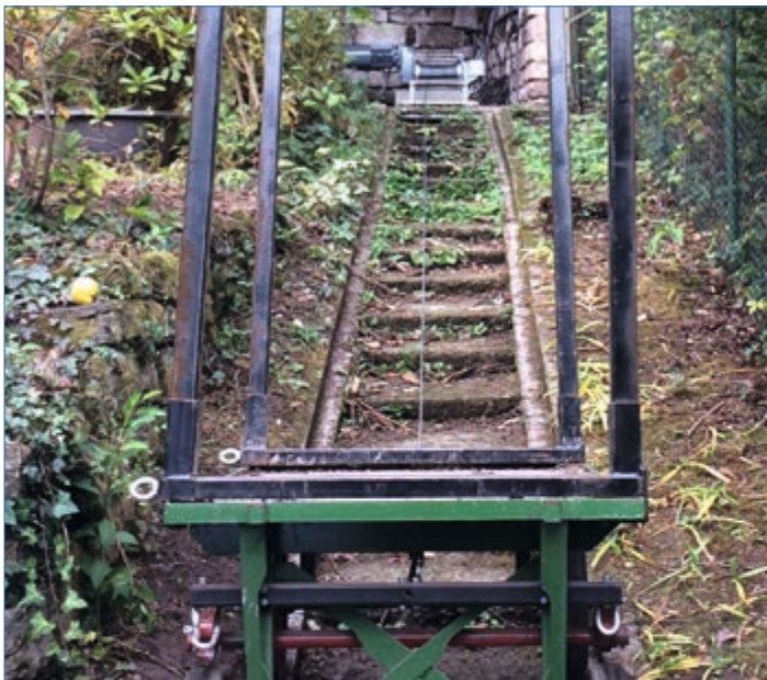
PFW-E 2000 als Hubwinde für Rotorblattprüfungen
