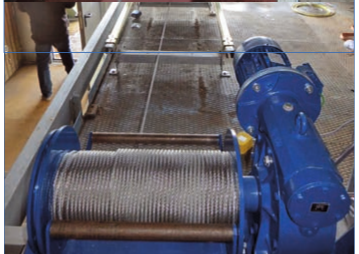
MC-E 2200 als Hubwinde für Spurfräse an Skisprungschanzen
