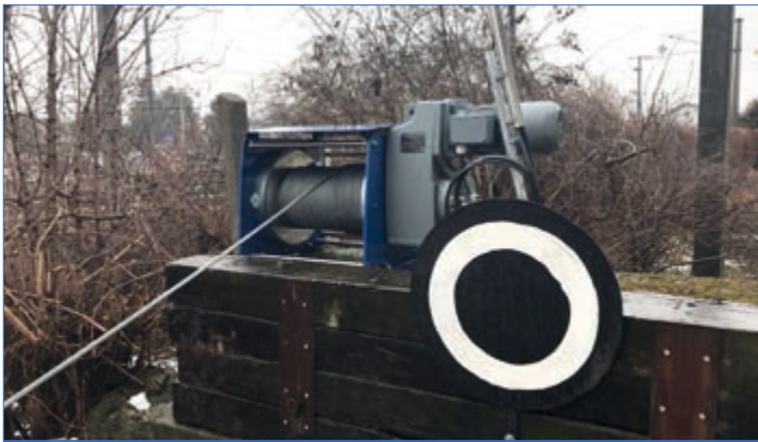
PFW-E 1000 als Zugwinde für Eisenbahnwagen
