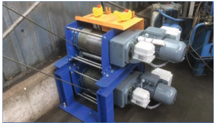
PFW-E 1000 als Doppelwindenbock für einen Prüfstand
