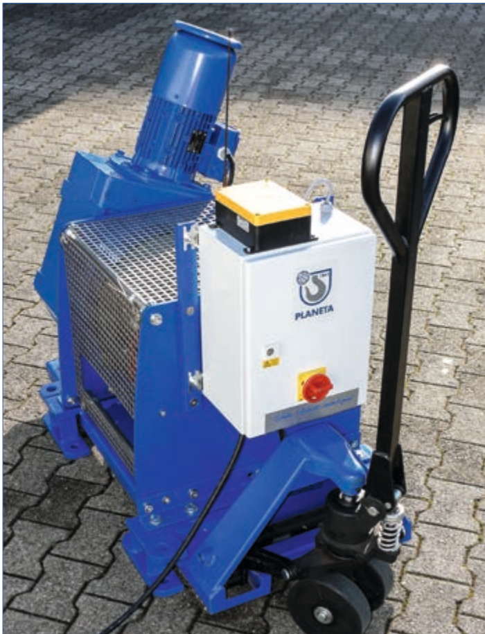
PFW-E 3000 als mobile Hubwinde für den Materialtransport
