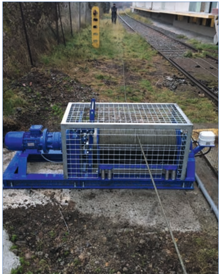
SB-E 305 als Traversierwinde an Waggonbefüllstation
