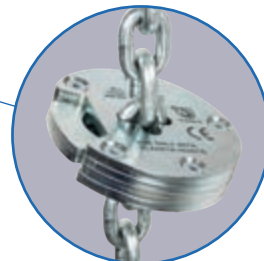
Optional: Kettensperrschloss verhindert ein Durchrutschen der Lastkette durch das Hubgehäuse.
